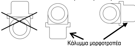
Εικ. 6: Συνιστώμενη θέση τοποθέτησης στη μέτρηση ψύχους
